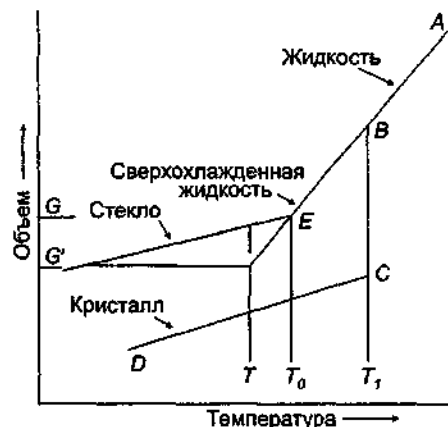
Рис II.5.1 Взаимосвязь между стеклообразным, жидким и кристаллическим состояниями вещества
